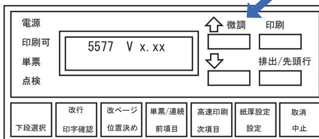
3. 下段スイッチを押す。ゲダンキノウと表示されていることを確認して、位置決めスイッチを押します。
